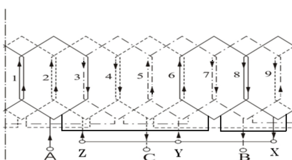
Рис. 2.2. Схема трехфазной петлевой обмотки с дробным q = 3/4
