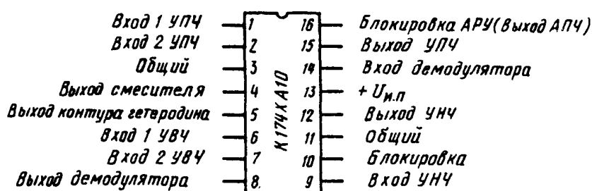
Рис. П.4.48 — Назначение выводов ИМС К174ХА10
