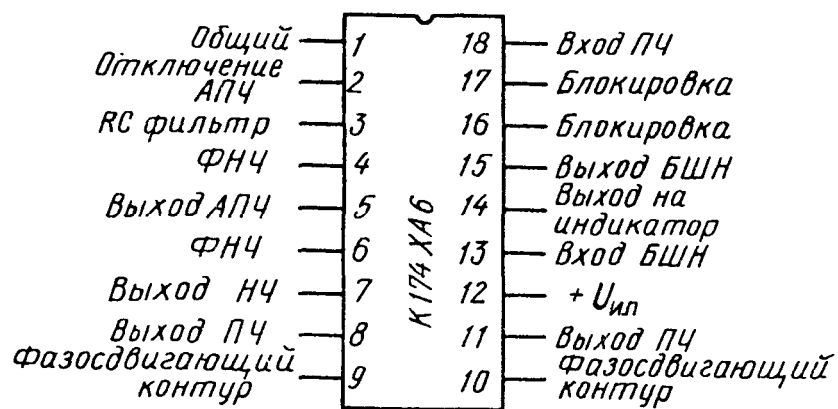
Рис. П4.42 — Назначение выводов ИМС К174ХА6
