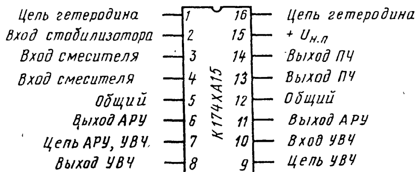
Рис. П4.51 — Назначение выводов ИМС K174XA15
