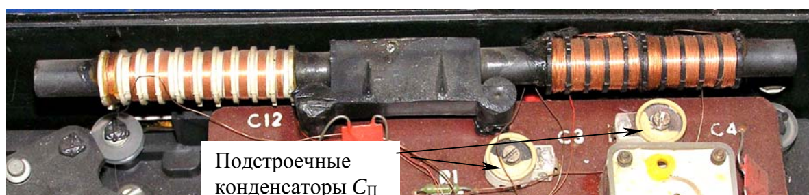
Рис. 3.21 — Конструкция магнитной антенны с секционированием контурных катушек ДВ- и СВ-диапазонов
