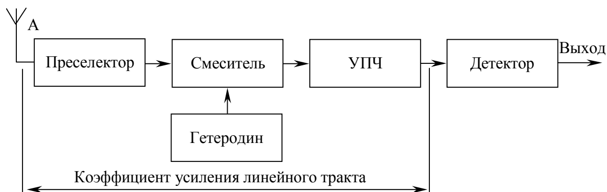
Рис. 2.6 — Структурная схема супергетеродинного радиоприемника
