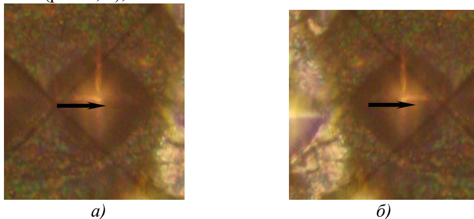
Рис. 2. Измерение диагонали отпечатка алмазной пирамидки.
