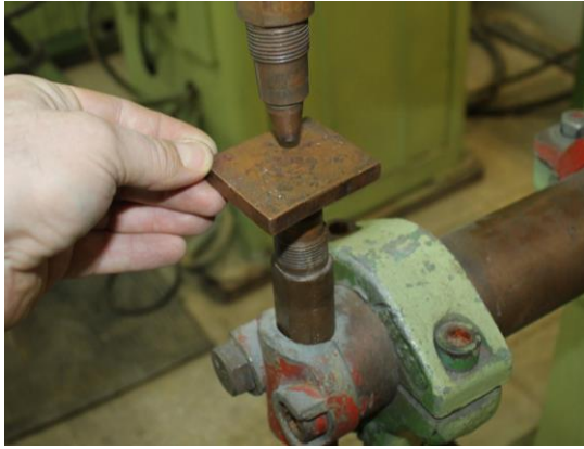
Пластина из меди М2 толщиной 10 мм размещена между электродами
