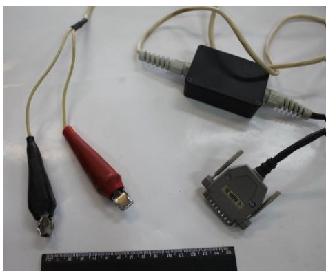
Датчик первичного напряжения (до 600 В)
