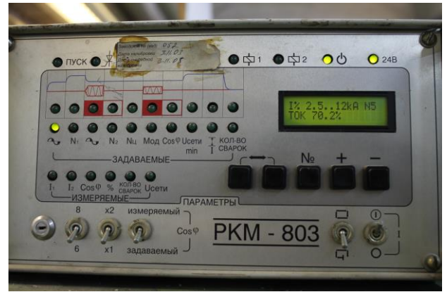
Настройка регулятора контактной сварки на угол открытия тиристоров 90 электрических градусов
