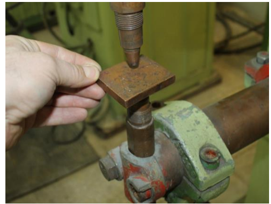
Пластина из меди М2 толщиной 10 мм размещена между электродами
