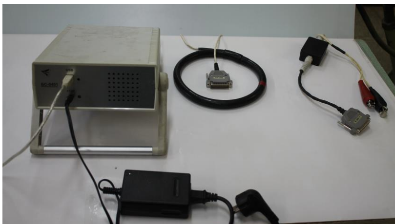
Регистратор РКДП-0401, блок питания регистратора, датчик вторичного тока и датчик первичного напряжения
