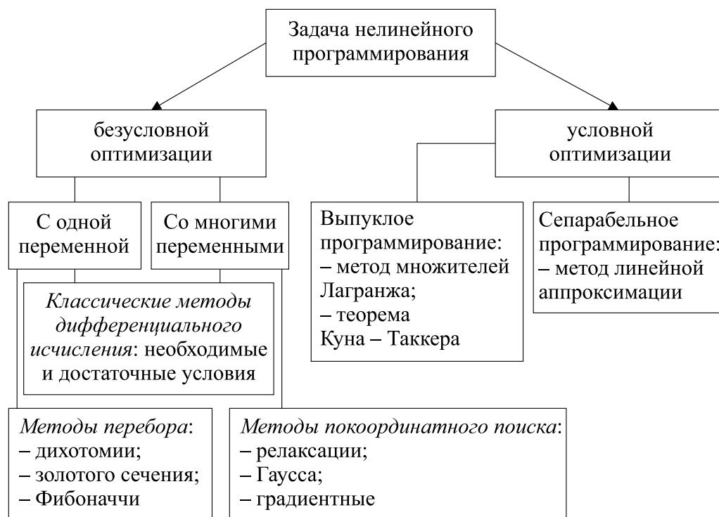
Рис. 5.1 – Классификация задач и методов нелинейного программирования
