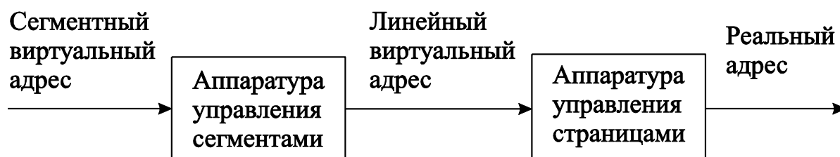
Рис. 6.1 – Состав аппаратуры управления памятью
