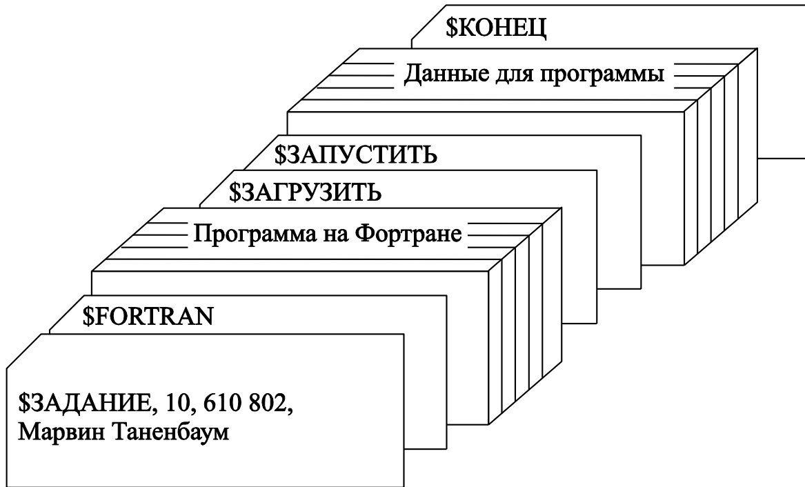
Рис. 1.2 – Структура типичного задания для операционной системы FMS
