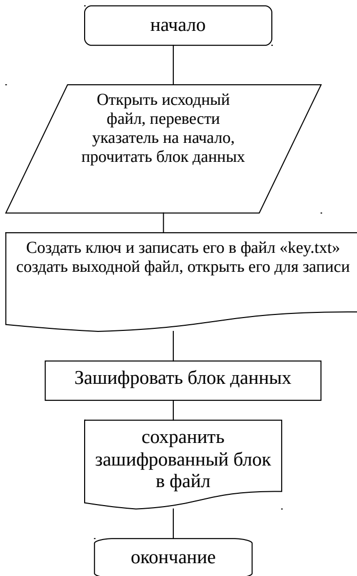
Рисунок 1. Блок схема алгоритма шифрования
