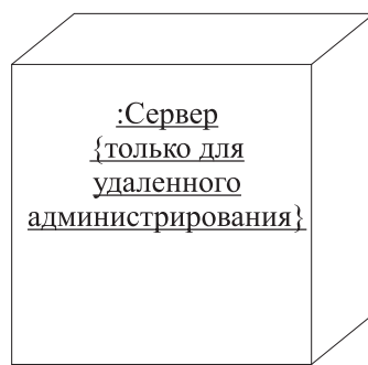
Рис. 5.33 – Графическое изображение узла-экземпляра с дополнительной информацией в форме помеченного значения
