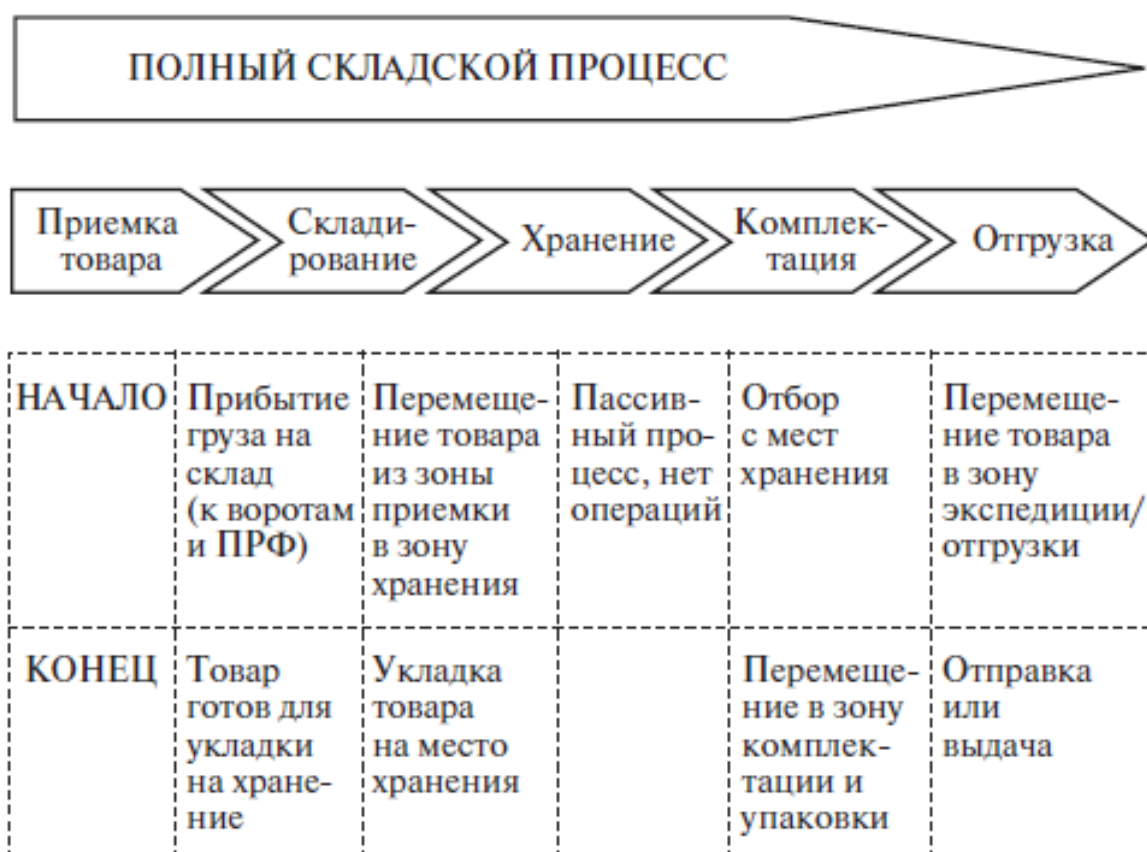
Рис. 1. Последовательность выполнения складских процессов
