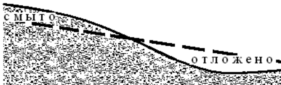
Рисунок 3- Строение делювиального склона
